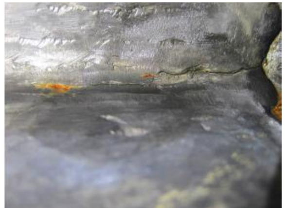
Bild: Från kontrollrapport. Vid provtryckning av rännan upptäcktes ett vattenläckage i rännans nedre del efter övergång till stellite svets. Efter närmare granskning ser man också att svetsen har spruckit i detta område.
