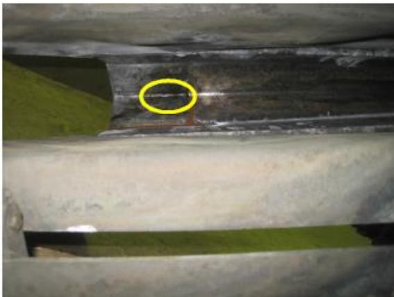
Bild: Från kontrollrapport. Vid provtryckning av rännan upptäcktes ett vattenläckage i rännans nedre del efter övergång till stellite svets. Efter närmare granskning ser man också att svetsen har spruckit i detta område.
