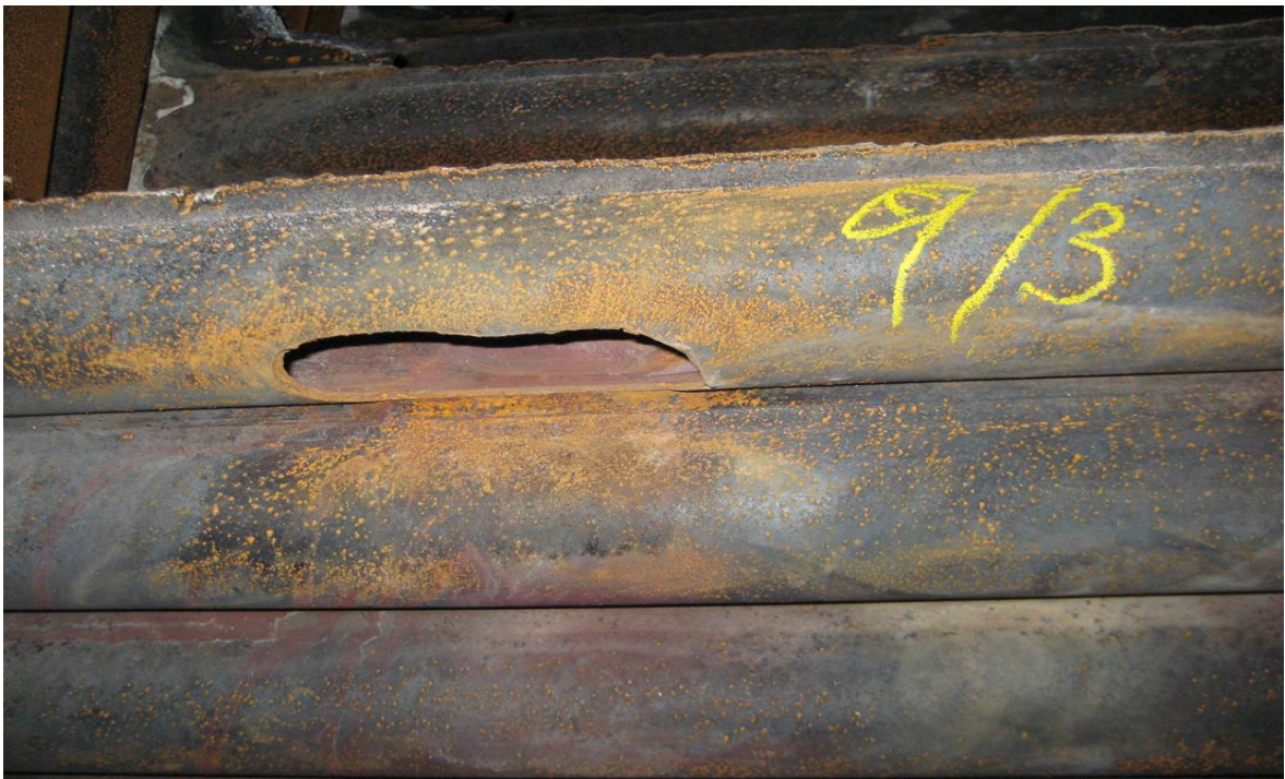
Bild: En tub i panel nr 9 överhettas, och öppnar sig.
