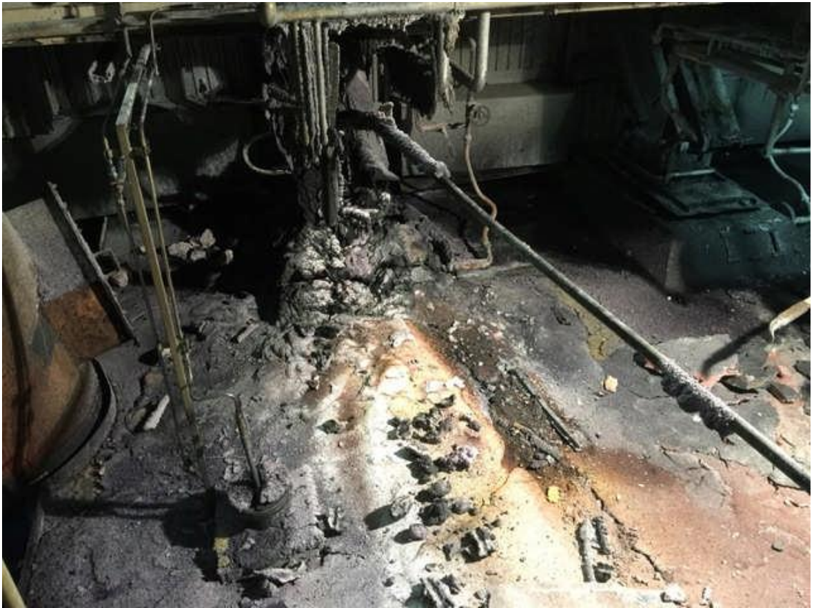
Bild: Hur det såg ut efter löprännehaveriet.
