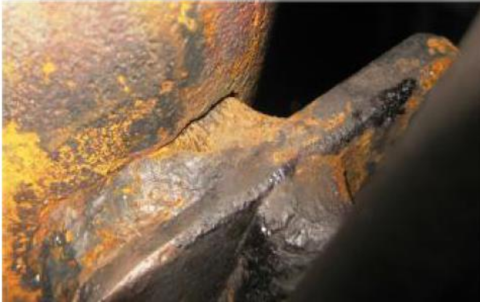
Bild: Sprickan invid fästjärnet.
