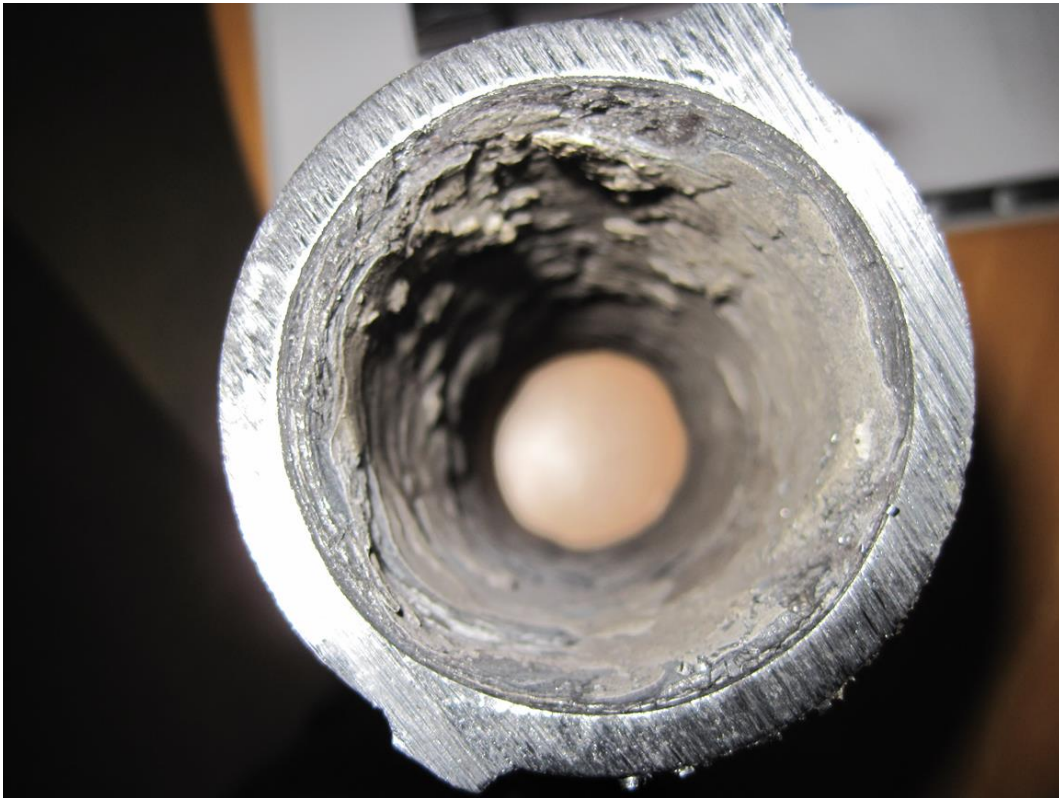
Bild: Tubprov från screenet.
